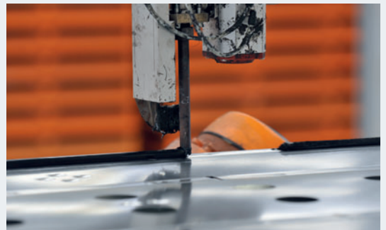
Automatisch wird der Terostat MS-Klebstoff auf die Stahlrahmen gespritzt. Darauf werden die Spiegel geklebt.
