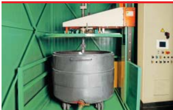
Les récipients destinés au mélange sur le site de production de Cerano en Italie sont maintenant nettoyés avec de l'eau à haute pression au lieu de solvants.
